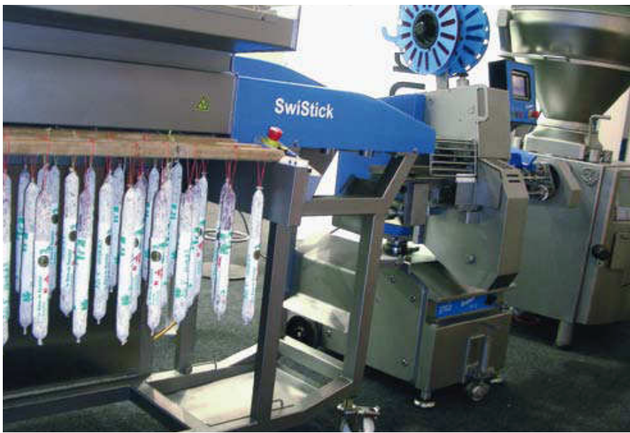
Neu von Tipper Tie Alpina ist die SwiStick-Aufhängelinie für das automatische Aufhängen der Würste auf Rauchstöcke. Die Bandschlaufen werden vom SwiStick direkt vom Bandschlaufenzubringer des Clippers übernommen.
