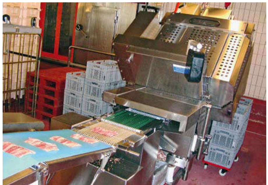
Vollautomatische Schneidmaschinen sind programmierbar für Scheibenanzahl, Fächerabstand, Portionenanzahl, Schnittstärke und einiges mehr.
